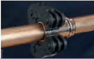
1. Mettre en place l'anneau de sertissage
