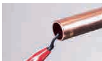
3. Utilisez un ébavureur de type crayon sur les bords internes
